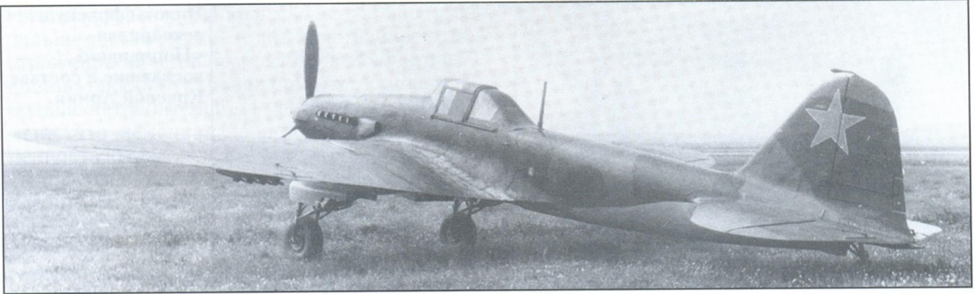
В начале войны Ил-2 выпускались исключительно в одноместном варианте без оборонительного вооружения
