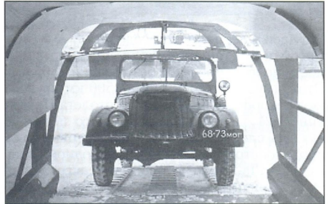
Отработка погрузки армейского автомобиля в вертолет В-8
