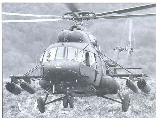
Ми-171Ш венесуэльской армии. На пилонах по бокам фюзеляжа видны контейнеры с 23-мм пушками (ближе к фюзеляжу) и пусковые установки для 80-мм неуправляемых ракет
