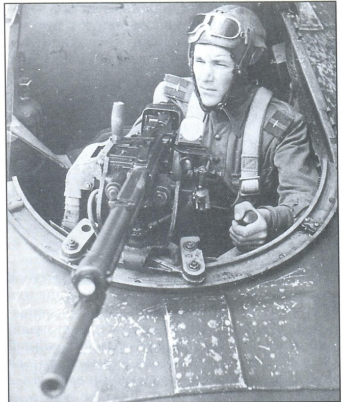
Во второй половине войны все Ил-2 уже оснащались крупнокалиберным пулеметом
