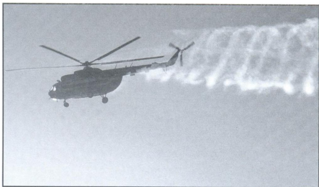
Ми-8 в Арктике. На 50-градусном морозе за винтом вертолета образуется инверсионный след причудливой формы
